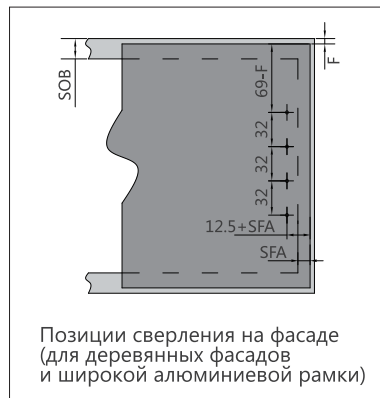
Позиции сверления для саморезов
